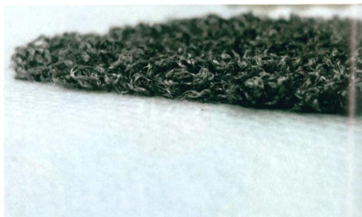
Abbildung 6: Moosgestickte Elektrode aus silberbeschichtetem Polyamidgarn SHIELDEX 110/34 dtex 2 ply HC der STATEX GmbH, Bremen
