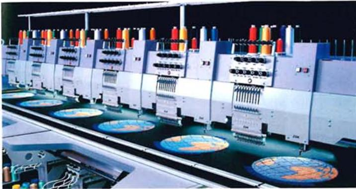
Abbildung 3: Mehrkopfstickmaschine mit sechs Köpfen für die Moos- und Kettelstickerei [Bildquelle: ZSK Stickmaschinen GmbH, Krefeld]
