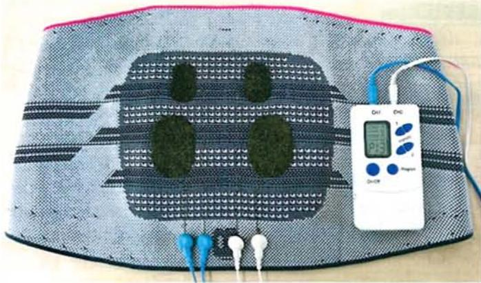
Abbildung 7: Elektrostimulationsrückenbandage mit moosgestickten Elektroden zur TENS-Therapie bei Rückenschmerzen
